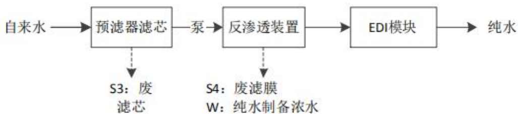
图 2-3 纯水制备工艺
