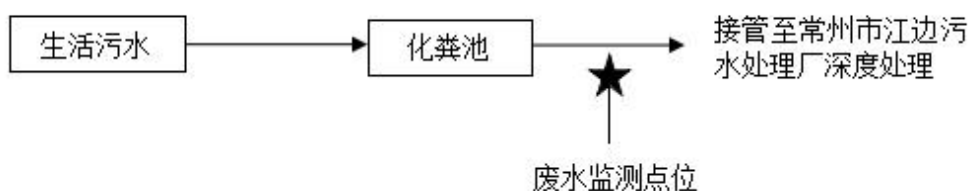
图 3-1 污水走向及监测点位图
